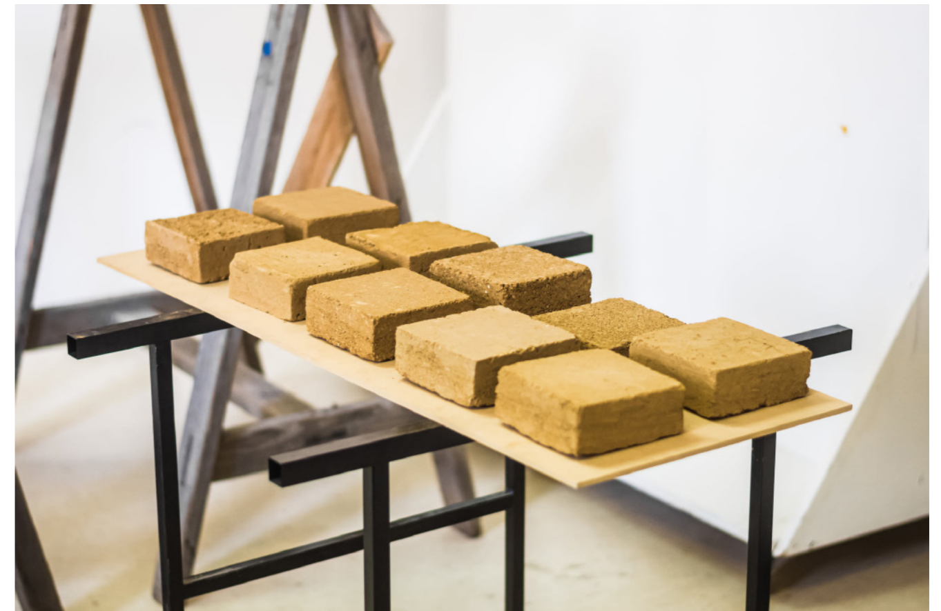
Briques de terre pisée ou compressée, comparaisons terre du Limousin et terre des Yvelines
