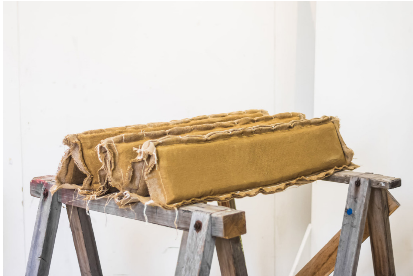
Poutrelles en terre armée de toile végétale pour plancher collaborant en terre et fibre végétale
